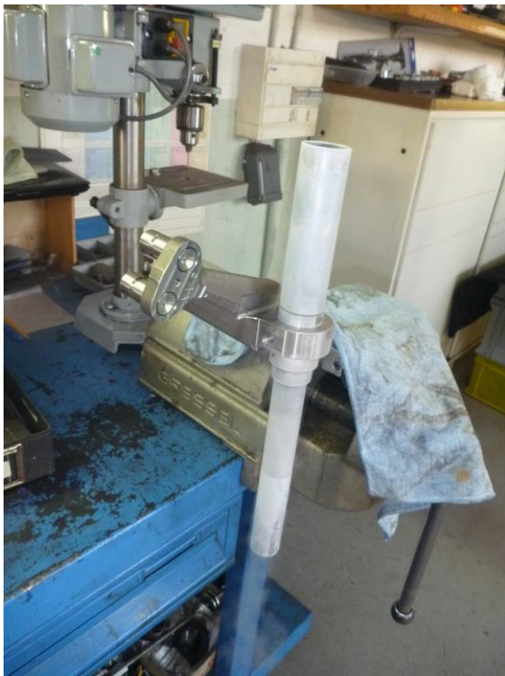
Das Achsschenkelrohr sitzt im Achsschenkel. Beim Zusammenbau – man sieht den Lenkarm.
