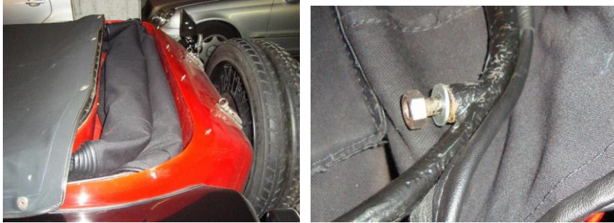
Das Verdeck verschwindet im Kasten. Bolzen und Mutter, um das Verdeck an der Windschutzscheibe zu befestigen (im Original eine Flügelmutter).
