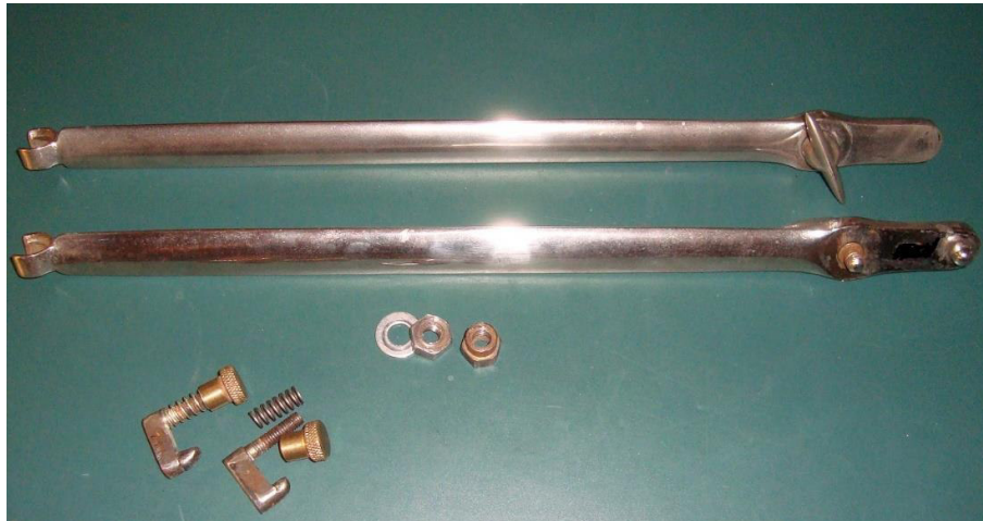
Die beiden Säulen, die an der Frontscheibe befestigt werden, und 2 Einsätze mit Federn und Rändelmuttern zur Stabilisierung des Verdeckgestells.
