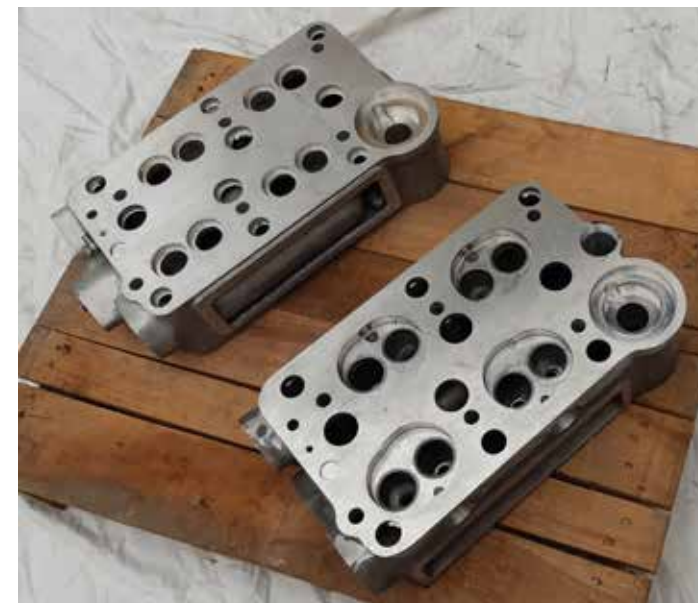
Foto 87: Testate cilindri Lancia Lambda (a sinistra delle prime serie a destra delle serie posteriori)
