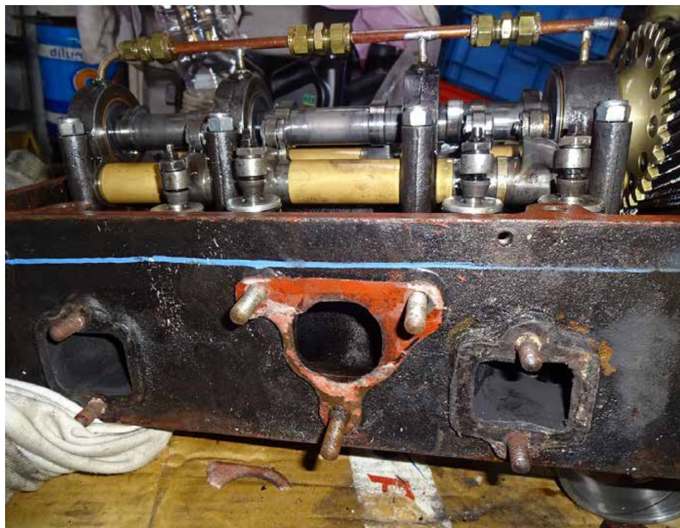
Foto 73: La testa cilindri della Lancia Lambda sviluppata da Bob West negli anni '40
