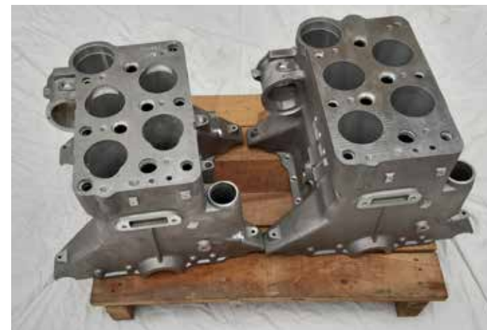
Foto 86: blocchi cilindri Lancia Lambda (a sinistra delle prime serie, a destra delle serie posteriori)
